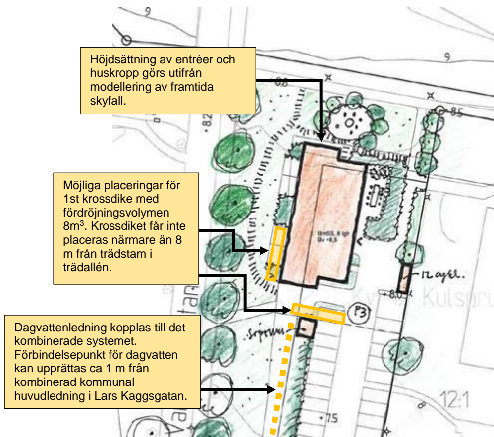
Figur 17 Föreslagna åtgärder för avvattning av planförslaget. Krossdiket i illustrationen är ungefär 17 m 2 stort.
